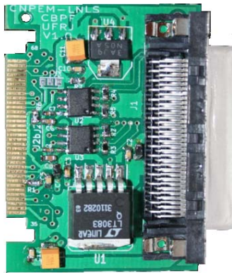
Figura 8: Primeiro protótipo montado da placa adaptadora (VHDCI68x90D_PCB_001 V1.0).
