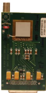
Figura 2: Placa de interface padrão do CERN com um Timepix montado. Foto: Jean Marie Polli.
