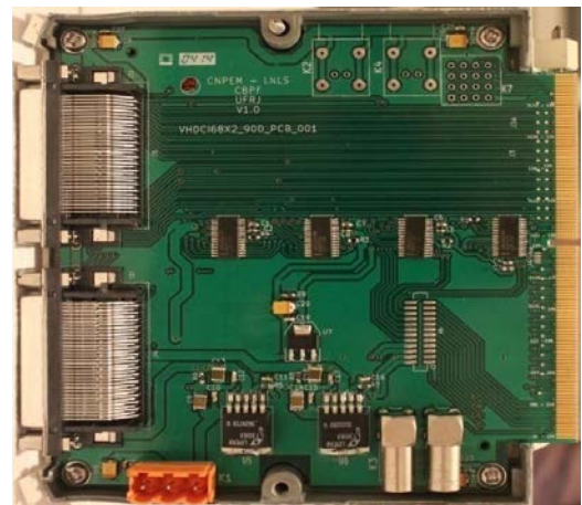
Figura 6: Primeiro protótipo da placa principal (VHDCI68x2.90D_PCB_001 V1.0) (vista superior).
