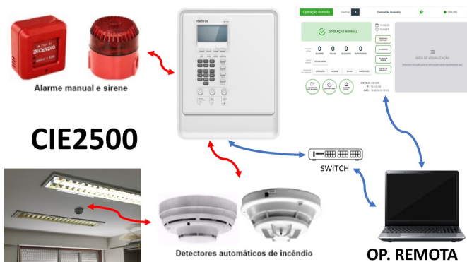
Figura 2. A central eletrônica CIE2500 e seus recursos para monitoramento.
