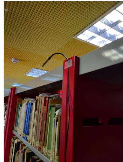
Figura 20: Sensor de Temperatura alocado na lateral da estante 2
