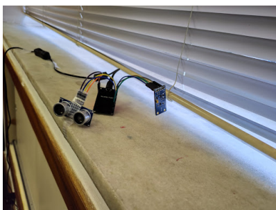
Figura 18: Sensores de luminosidade e distância integrados diretamente no microcontrolador.
