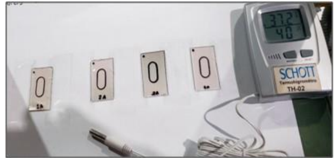
Figura 10: Imagem das amostras de FTO sendo exposta no ambiente de produção vidreira, termo-higrômetro [27] ao lado.
