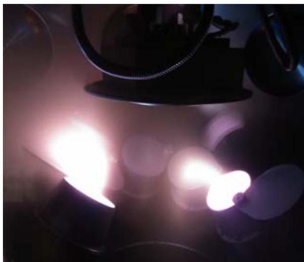
Figura 26: Plasma gerado pelos magnetrons durante a codeposição.
