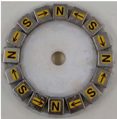
Figure 1: Ímãs permanentes do rotor em configuração Halbach. Estão indicados os pólos norte (N), sul (S) ou planar (setas) de cada um dos ímãs.
