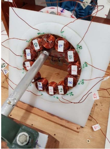
Figure 10: Estrutura de bobinas para o conjunto com um Estator Fonte: Arquivo do autor
