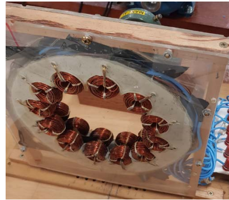
Figure 9: Estrutura de bobinas para o conjunto com dois Estatores
