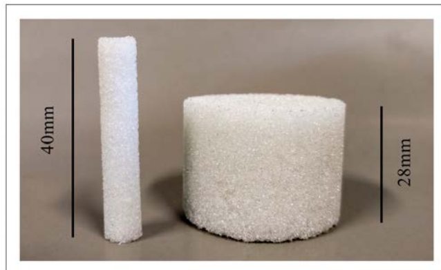
Figura 8: Amostras de rocha sintética produzidas com microesferas do intervalo D, nos tamanhos utilizados em RMN de alto campo (esquerda) e baixo campo (direita).
