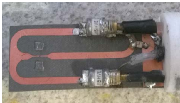
Figura 6: Fotografia da placa montada com o circuito ressonador.
