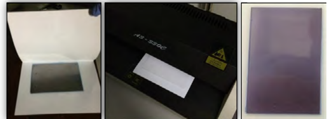
Figura 6: Processo de aplicação do dryfilm - Primeiro envolve-se a placa (com o filme) em papel ofício; depois coloca-se o conjunto na laminadora; e finalmente o dryfilm está completamente liso sobre a placa.
