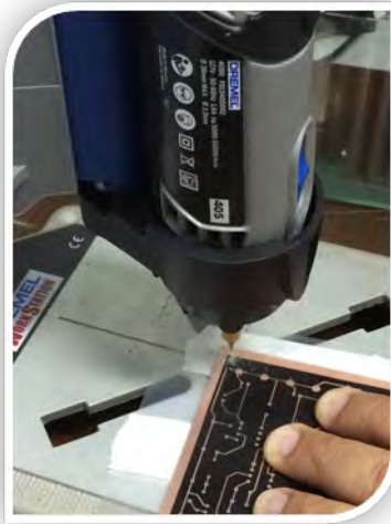
Figura 4: Furos de sincronismos usando-se o fotolito como base.
