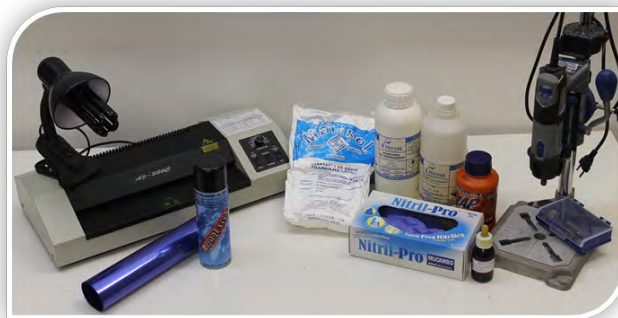
Figura 17: Materiais utilizados para a fabricação de PCB no LEPS pela técnica do dryfilm .
