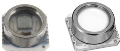
Figura 1: Foto do sensor MS5803-01. No sensor da esquerda é possível observar o elemento piezoelétrico, pois não foi adicionada a segunda camada de gel KE1052 com carga de TiO_2 , de cor branca.
