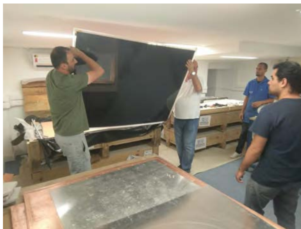
Figura 3: Outubro de 2019 – montagem da primeira RPC (Resistive Plate Chamber) do tipo MARTA no CBPF.
