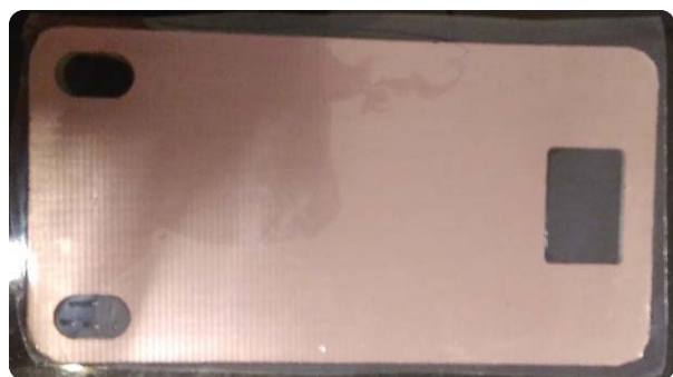
Figure 8: Dryfilm faceado na placa de cobre.
