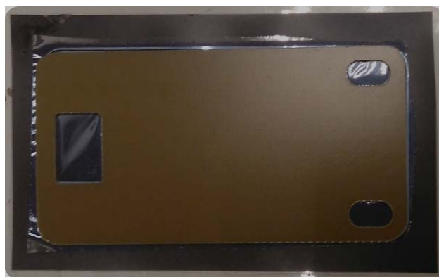
Figure 9: Placa já com o filme fixado e sobre a transparência, pronta para receber a fita adesiva transparente.
